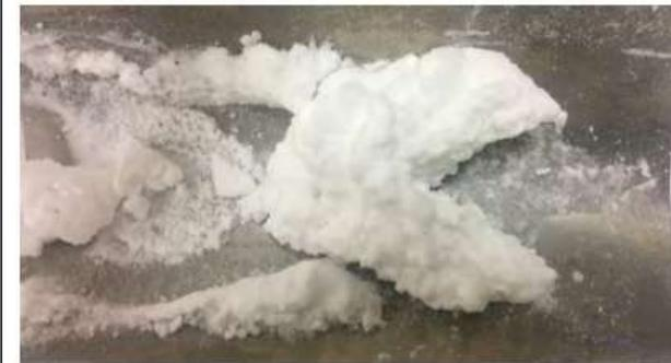
Abbildung 4: Ablagerungen durch Adblue-Einspritzung bei Temperaturen unterhalb von 180°C (Quelle: Börnhorst, Deutschmann, ITCP, KIT)
